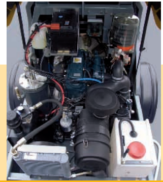
Модель М 730 оснащена мощным 3-цилиндровым дизельным двигателем.
