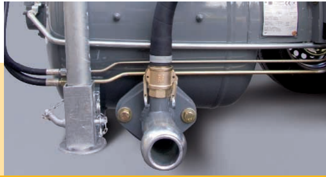
Напорный патрубок можно заменить в зависимости от диаметра подающего шланга.
