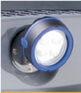
Новый галогеновый рабочий прожектор 50 Вт теперь входит в серийную комплектацию и устанавливается на заднюю часть Mixokret
