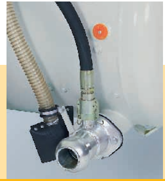
В зависимости от того, какой шланг необходимо подключить (NW 50, 65 или 90), напорный патрубок можно легко заменить.
