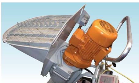
Projet Mix D2, приемный бункер с гребешком для разрывания мешков
